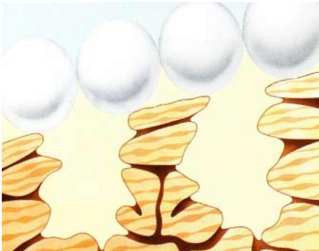
Eindringvermögen von Acrylbeschichtungen
