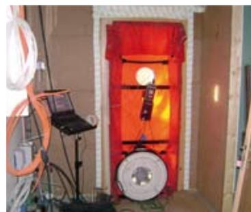
*Überprüfung der Luftdichtigkeit „Blower Door“*
