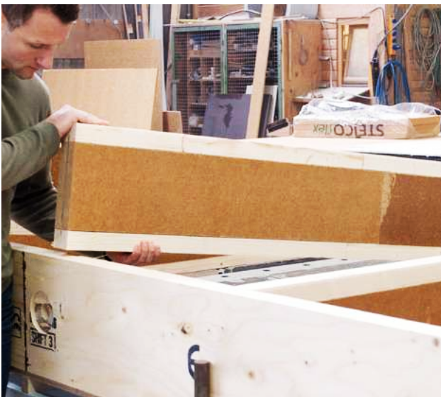
Vorfertigung von Wandelementen mit STEICO LVL R und STEICO Stegträgern
