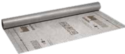
Knauf Insulation LDS FlexPlus Feuchtevar. Hochleistungs-Dampfbremsbahn. s_d -Wert: 0,2–20 m Flächengewicht: 75 g/m 2
