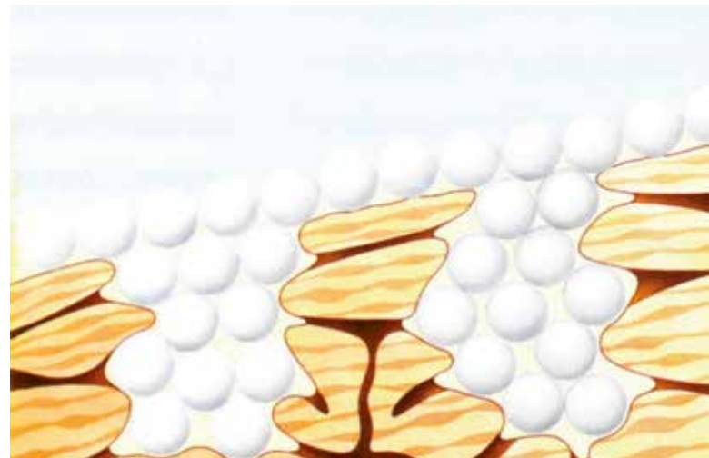
Eindringvermögen von ölmodifizierten Beschichtungen
